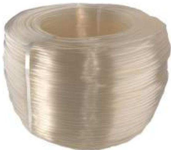
**CARATTERISTICHE TECNICHE:** Tubi a sezione costante destinati ad essere utilizzati nel settore medicale per il collegamento o il completamento di dispositivi medici differenti. Le materie prime utilizzate sono prive di plastificante DOP, il plastificante utilizzato è TOTM. Queste materie prime conferiscono ai tubi trasparenza, elasticità ed elevata flessibilità, caratteristiche queste indispensabili per la loro destinazione d'uso.
